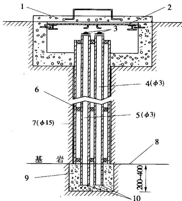
图 D. 3. 2 双金属标剖面图 (cm)
