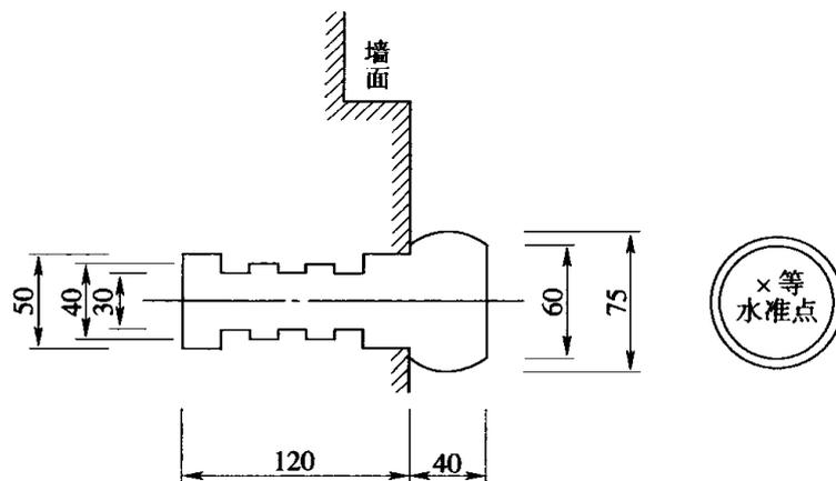
图 D. 1. 3 墙角水准点标志图(mm)
