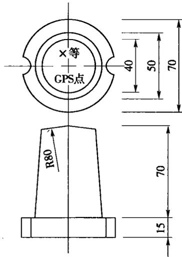
图 B. 1. 1 磁质标志图(mm)
