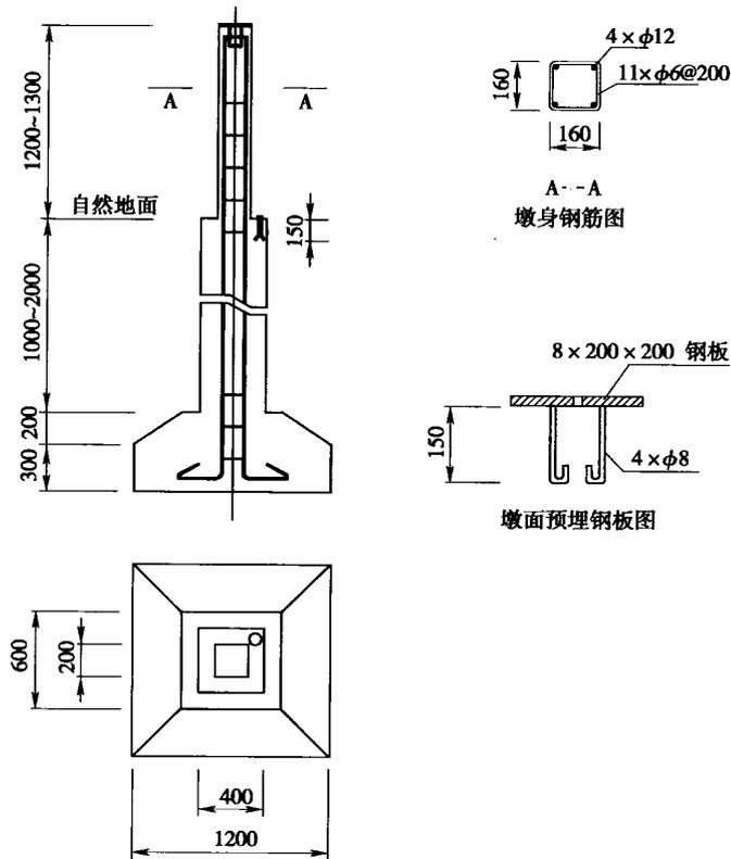
图 B. 3. 1 变形监测观测墩图(mm)
