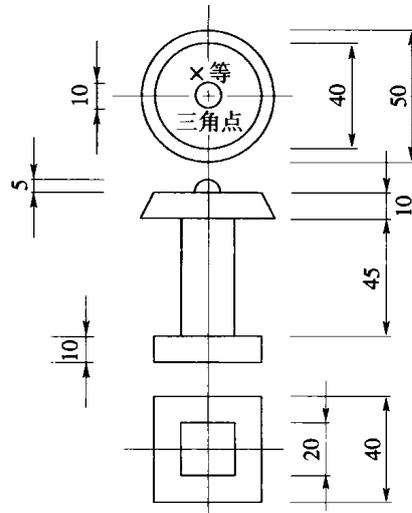
图 B. 1. 2 金属标志图(mm)
