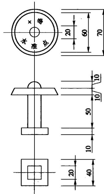
图 D. 1. 1-2 金属标志图(mm)
