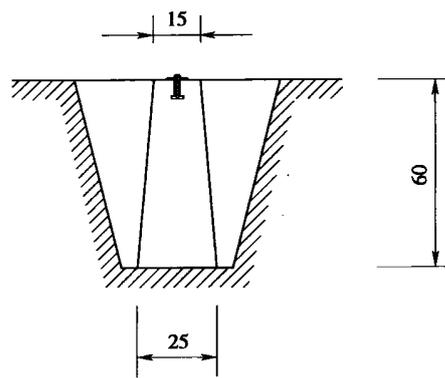
图 D. 2. 2 四等水准点标石埋设图 (cm)
