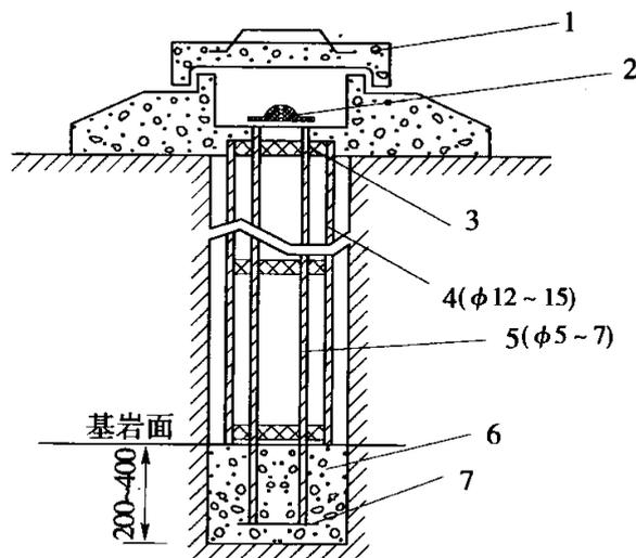
图 D. 3. 1 测温钢管标剖面图 (cm)
