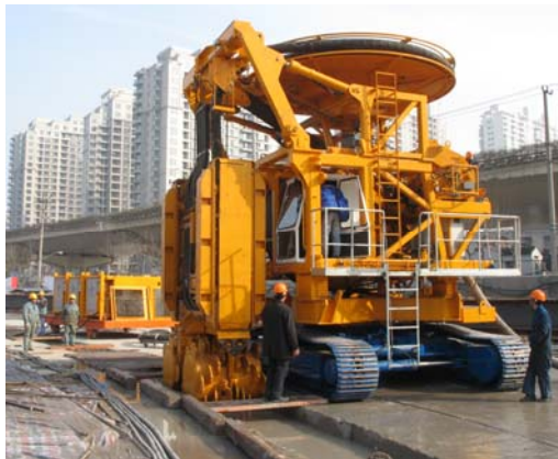
图 18-59 铣槽机成槽设备
