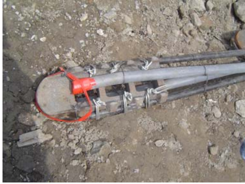
图错误！文档中没有指定样式的文字。-6 U型载体可拆芯锚杆端部构造图
